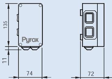
MP предназначен для всех воздушных завес с электронагревательной секцией. Имеет два переключателя - один для регулирования прокачки воздуха и другой для регулирования электрического подогрева воздуха. MP0 предназначен для воздушных завес без электронагревательной секции (LG0 и LGW) и имеет один переключатель скорости прокачки воздуха.
